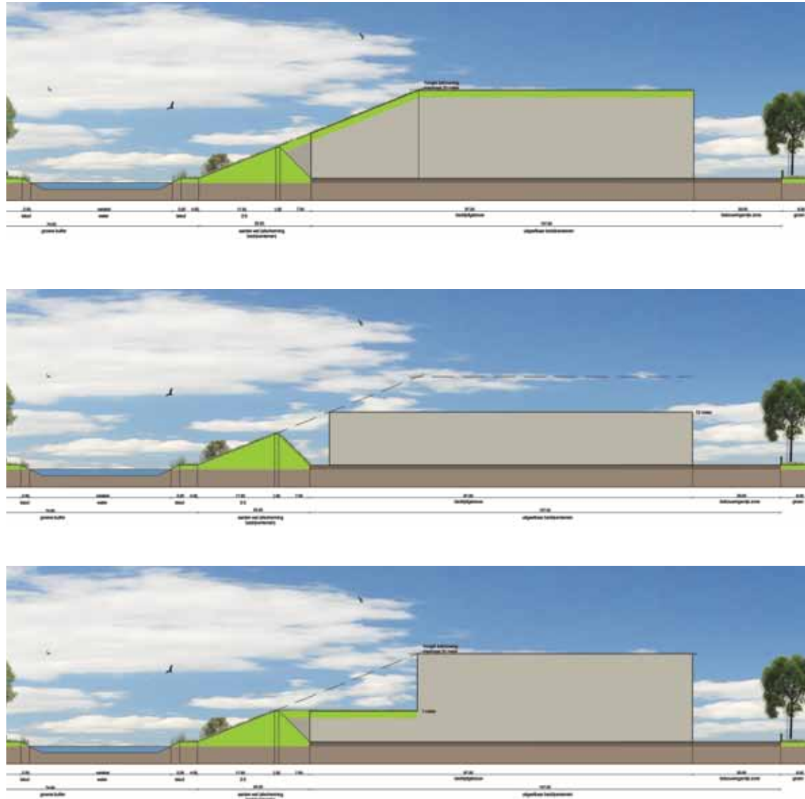
verschillende mogelijkheden overgang dijklichaam - bedrijfsbebouwing
